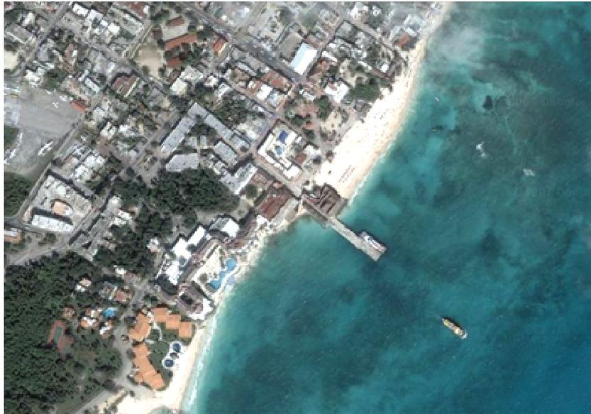
*Figura 42: Sedimentación y erosión costera (norte y sur respectivamente) generada por el muelle fiscal de Playa del Carmen (vista oblicua).
