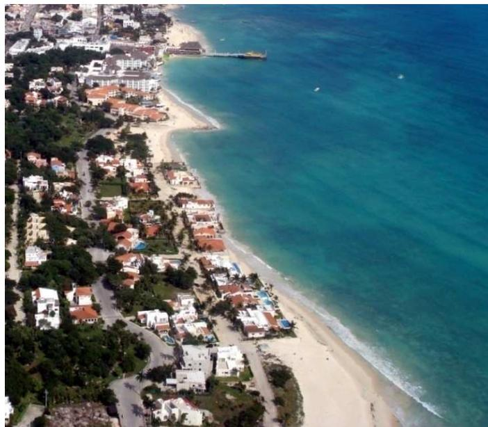
*Figura 41: Sedimentación y erosión costera (norte y sur respectivamente) generada por el muelle fiscal de Playa del Carmen.
